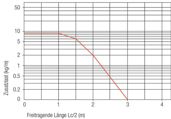
Zusatzlasten sorgen für einen Durchhang des oberen Kettenstrangs. Die Funktionsfähigkeit der Energieführungskette ist nicht beeinträchtigt, solange der Durchhang geringer ist als der Kettenradius.
