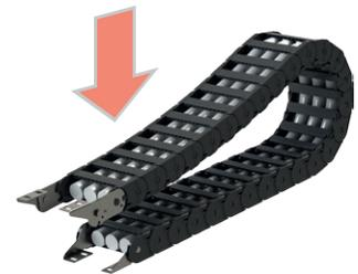
Zusatzlasten sorgen für einen Durchhang des oberen Kettentrums. Die Funktionsfähigkeit der Energieführungskette ist nicht beeinträchtigt solange, der Durchhang geringer ist als der Kettenradius.
