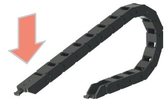
Zusatzlasten sorgen für einen Durchhang des oberen Kettentrums. Die Funktionsfähigkeit der Energieführungskette ist nicht beeinträchtigt, solange der Durchhang geringer ist als der Kettenradius.
