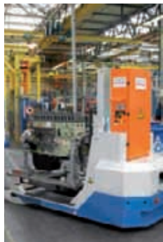
Flurförderzeug mit IPT®-Floor und iDAT
