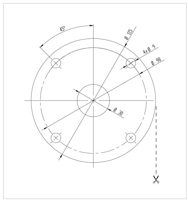
Fig. 4: Drilling Template BEF150/61-F001-0039
