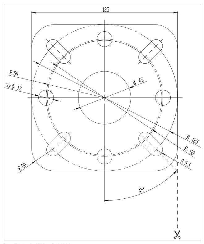
Fig. 5: Drilling Template BEF185 – 325/61-F001-0055
