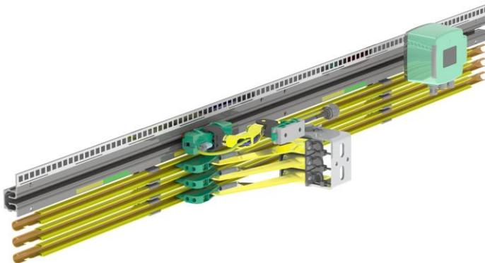
*BU:* ProfiDAT<sup>®compact</sup> bietet 3-in-1-Funktionalität: Es garantiert eine sichere Datenübertragung, dient als Schutzleiter und kann um ein optisches Positionierungssystem erweitert werden.
